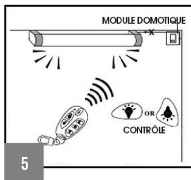
5 Pour piloter un appareil domotique, pressez le bouton ampoule. Nécessite l'installation d'un module domotique PL708R.
