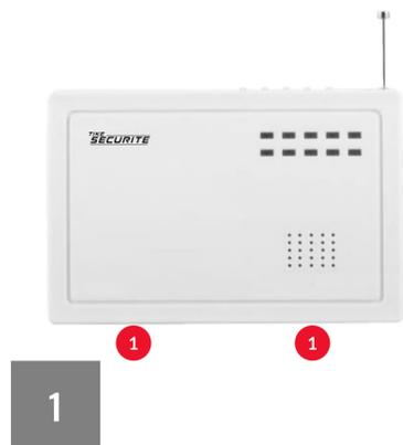
Ouvrez le répéteur en insérant un tournevis plat dans les encoches situées dans la partie inférieure du répéteur et un appuyant vers le bas.
