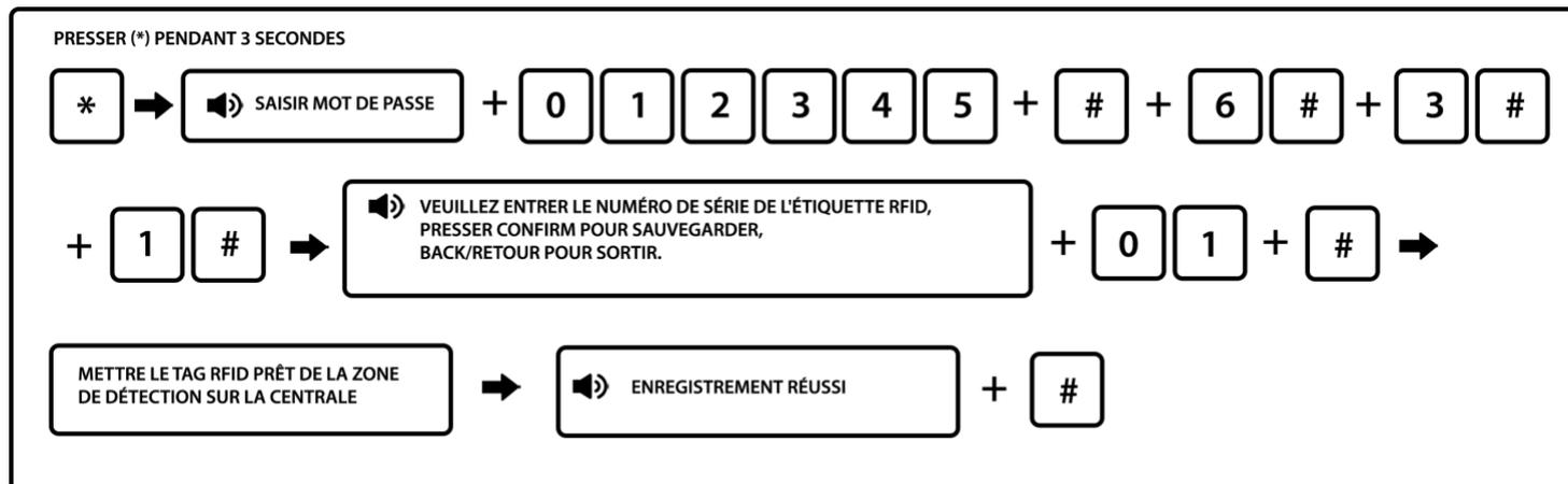
Le numéro de série correspond à l'emplacement du tag RFID de 01 à 16. Vous pouvez connecter jusqu'à 16 télécommandes/claviers/tags.
