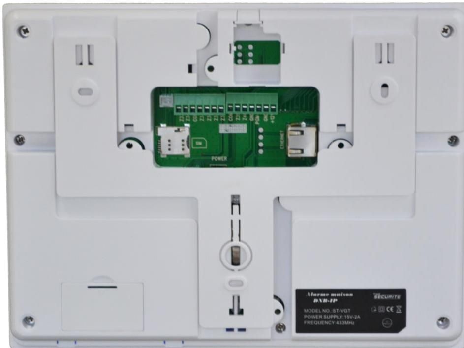
1. Faites glisser le socle arrière vers le bas pour l'enlever et pouvoir le fixer au mur. Faites des repères sur votre mur et percez les trous puis fixez le socle à l'aide des vis et chevilles fournies.
