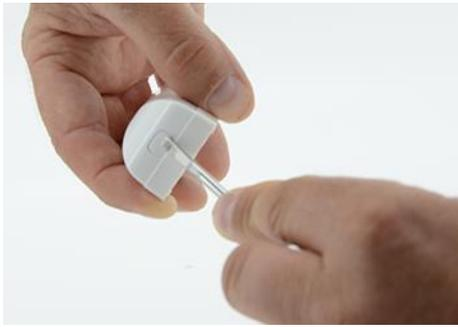
1. A l'aide d'un tournevis plat, ouvrez l'émetteur en insérant votre tournevis dans l'encoche et en appuyant vers le bas.
