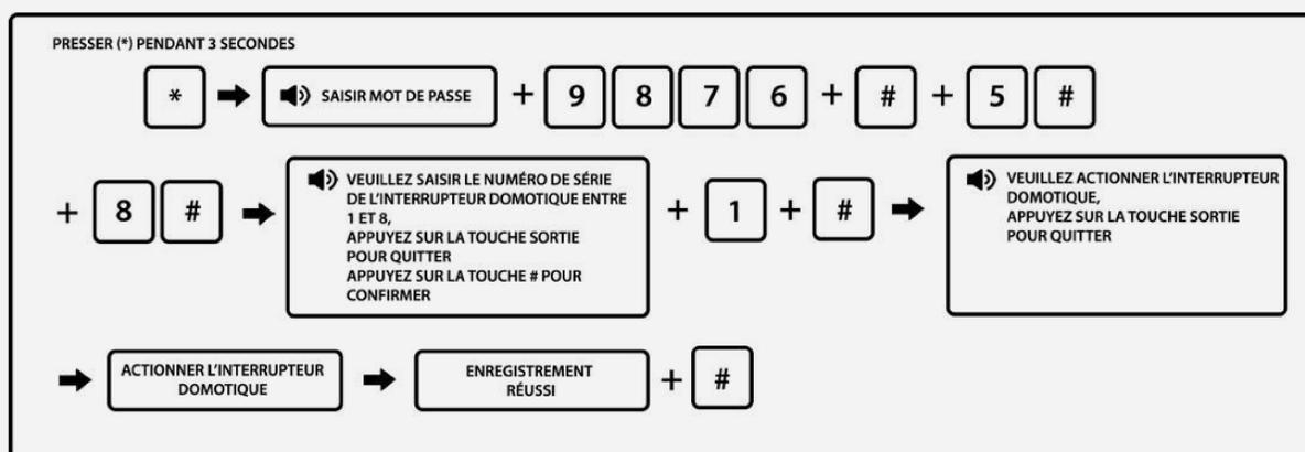
Pour actionner l'interrupteur domotique, vous devez appuyer quelques secondes sur le bouton d'enregistrement puis sur la voie à enregistrer :
