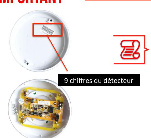
>> Ouvrez le détecteur de mouvement plafonnier en maintenant la face arrière et en faisant pivoter la face avant.
