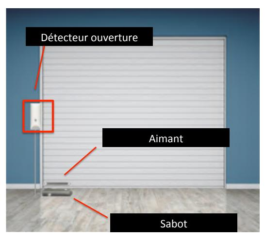
>> Posez le détecteur d'ouverture sur le mur porteur. L'aimant sur la porte de garage. Le sabot au sol.
