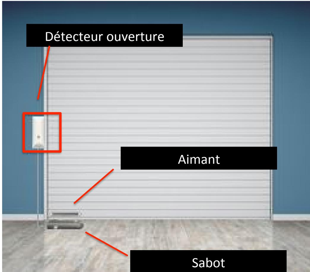
>> Posez le détecteur d'ouverture sur le mur porteur. L'aimant sur la porte de garage. Le sabot au sol.
