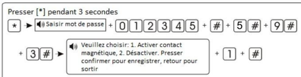
5.9.4 Contrôler le détecteur anti-vandalisme sans fil : si le détecteur est activé, en cas d'altération du détecteur l'alarme se déclenche. Si il est désactivé, l'alarme ne se déclenche pas (le contrôle est activé par défaut)
