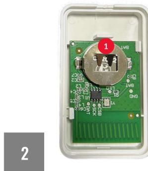
Poussez l'ancienne pile et remplacez par la nouvelle.
