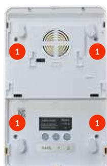
Dévissez les 4 vis au dos de la sirène. Retournez la sirène et ouvrez le couvercle. Ne pas retirer les vis du panneau solaire.
