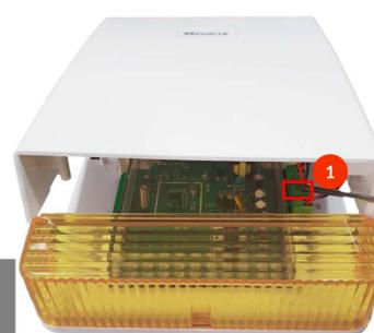
Branchez la batterie de secours sur la platine électronique. Refermez correctement la sirène et revissez les 4 vis au dos.
