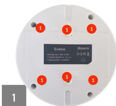
Dévissez au dos de la sirène les 6 vis afin d'ouvrir celle-ci. 1
