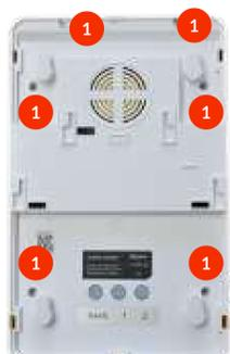
Dévissez les 6 vis au dos de la sirène. Retournez la sirène et ouvrez le couvercle.
