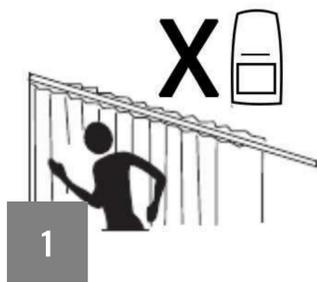
Ne pas placer face à un mur métallique
