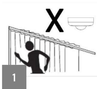
1 Ne pas placer face à un mur métallique
