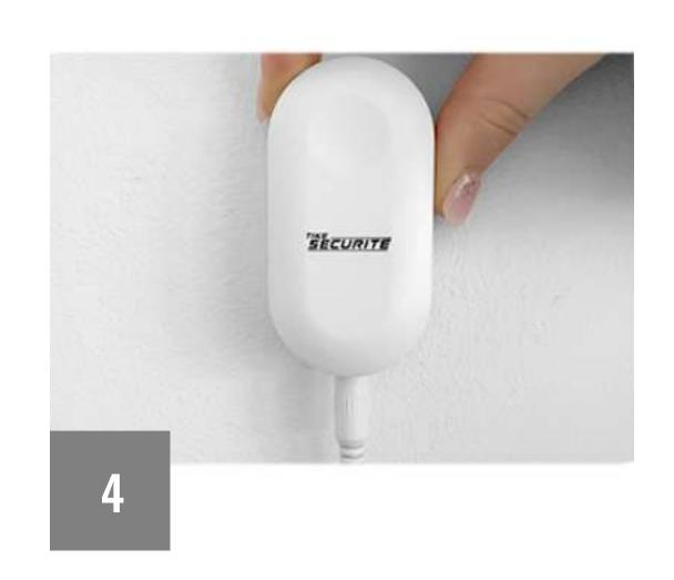
Clipsez fermement le capot sur le supports vissé, puis connectez le câble au détecteur.
