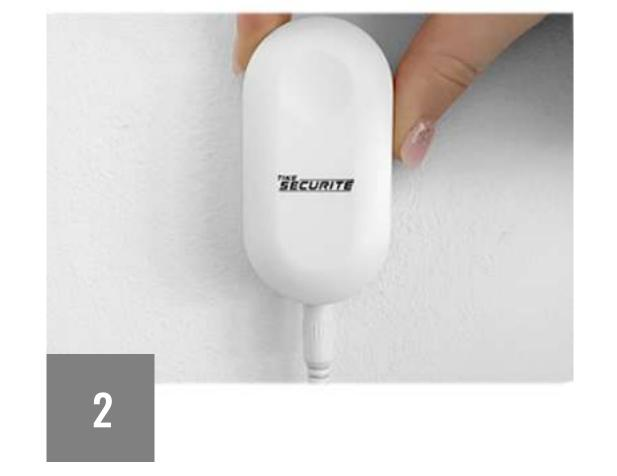
Installez la sonde sur votre mur de sorte que les 2 capteurs fassent contact avec le sol. Installez ensuite le détecteur à moins d'1m40 de la sonde et branchez le câble.
