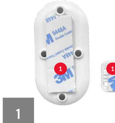
Après avoir noté le numéro de série à 9 chiffres du détecteur, placez une bande adhésive au dos du détecteur et une au dos du support de la sonde.
