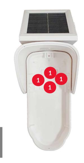
Après avoir devisser les 2 vis se trouvant en dessous du détecteur, viser le socle du détecteur sur le support de la rotule que vous avez préalablement fixé au mur.
