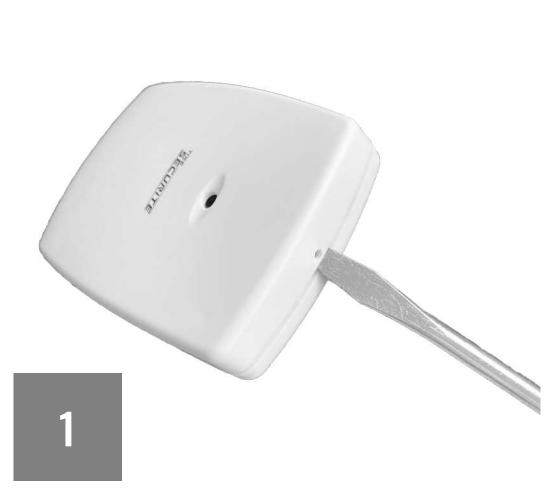
A l'aide d'un tournevis plat, ouvrez le détecteur en insérant votre tournevis dans l'encoche située en haut et en appuyant vers le bas.
