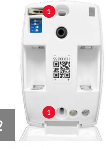
Vissez le socle du détecteur au mur à l'aide des vis fournies, puis reclipsez fermement le détecteur.
